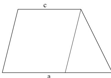
Auf diese Weise kann das Trapez in ein Parallelogramm und in ein Dreieck zerlegt werden, von denen jeweils eine Seite und die entsprechende Höhe bekannt sind.
